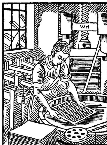
Ab. 1 Papierer mit Schöpfsieb an der Bütte, Spindelpresse, Stampfwerk und Wasserad. (Zur Verfügung gestellt von der Papierfabrik Zerkall Renker & Söhne.)
