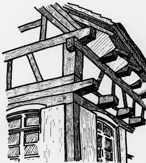
Abb. 39a. Hausecke mit vorspringender Balkenlage aus Schutterwald.
